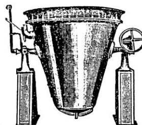
Fig. 87 - Caldaia da formaggio a vapore (tipo rocciano).
